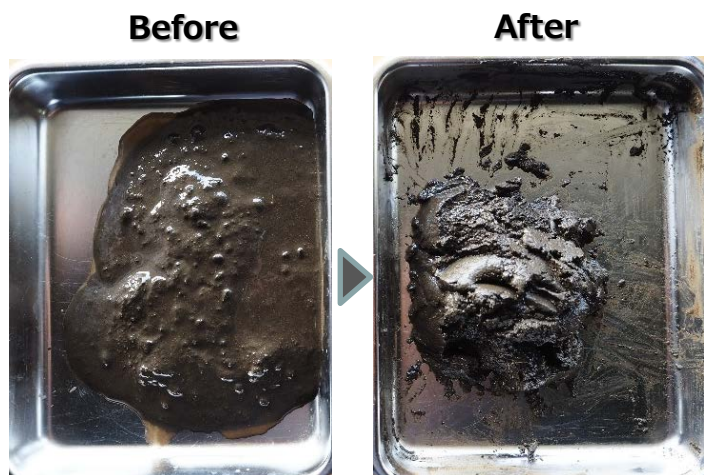
実験：200gの泥水（左側）に対して、10gの コアソリッド®を入れた状態（右側）
